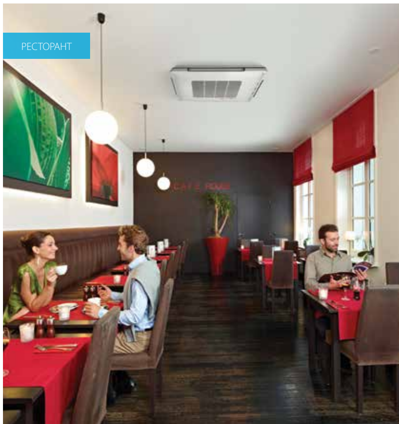
Таванна касета с кръгъл поток FXFQ-A: 360° разпределение на въздушния поток за оптимална ефективност и комфорт
