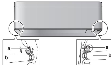
**a** Винт за закрепване на изолация
