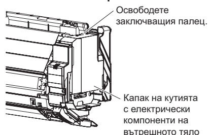
Фигура 1: Сваляне на капака от кутията с електрически компоненти на вътрешното тяло
