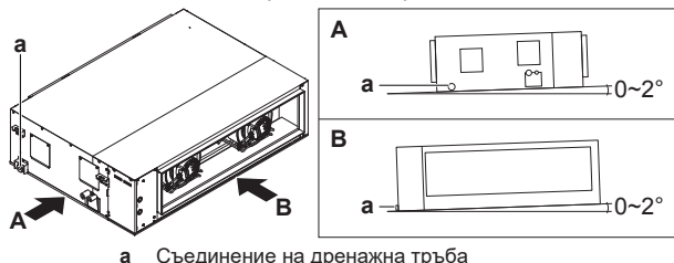
a Съединение на дренажна тръба
