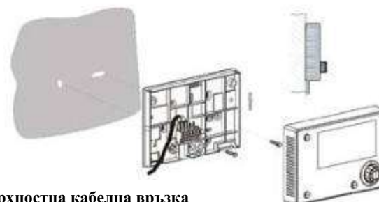
Повърхностна кабелна връзка
